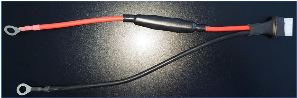
这张相片是 BACS 电池管理系统典型的 BC5 无卤素 (Halogen Free) 电池量测线，可以明显看到 1,000V 的气密式密封型高压保险丝，气密式密封型可以防止电池于充电过程中所泄出的氢气被点
