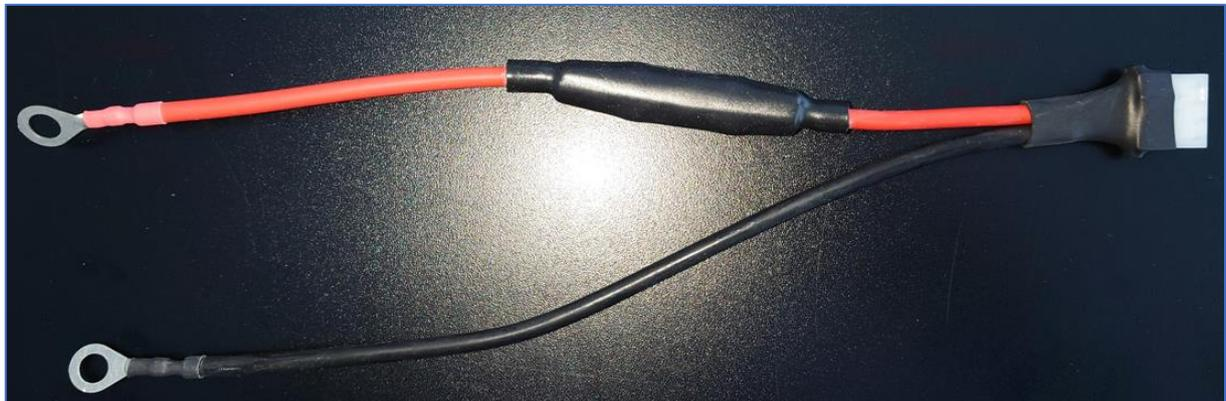
這張相片是 BACS 電池管理系統典型的 BC5 無鹵素 (Halogen Free) 電池量測線，可以明顯看到 1,000V 的氣密式密封型高壓保險絲，氣密式密封型可以防止電池於充電過程中所洩出的氫氣被點
