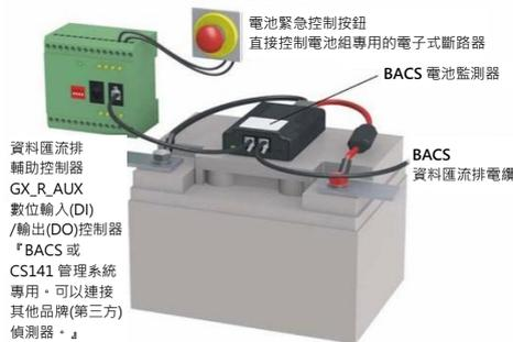
BACS 電池管理系統能夠透過監測每顆電池/每單顆電池的溫度和(可選購)的電池組(串)電流來檢測出熱失控的風險。如果熱失控被檢測到，BACS 電池管理系統會將電池組(串)的電子斷路器自動觸發跳脫，從而斷開及隔離電池組(串)。這個原則是符合 2018 國際消防法規 —— International Fire Code (IFC) —— 第 1206.2.10.7 章節的規範，並且在美國這個國家對於電池的安裝是強制性必須符合這個規範。
